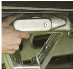
Encajar el Safety en la ranura y empujar hacia la derecha
